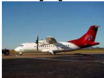
ATR 42-320 Fluggeschwindigkeit: 440 km/h Aktionsradius bei Vollast: 1.389 km Anzahl Passagiere: 49 Y-Class
