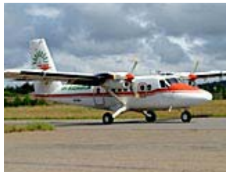
De Havilland DHC 6 "Twin Otter" Fluggeschwindigkeit: 270 km/h Aktionsradius bei Vollast: 750 km Anzahl Passagiere: 19 Y-Class
