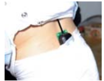
Windelpack mit Elektronik! Angeklebter Sensor misst dreidimensionale Beschleunigung am Lendenwirbel.
